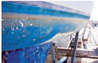
Verfblaasjes en omhooggetrokken verf
